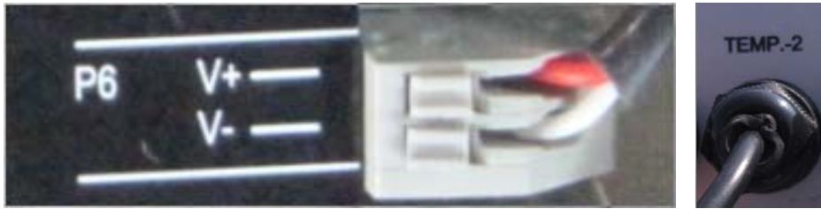
图 4-6 环境温度传感器各芯线连接
