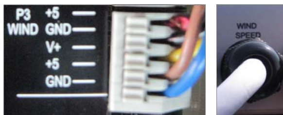
图 4-3 风速传感器各芯线连接
