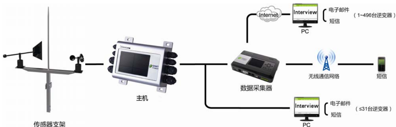
图 1-1 环境检测仪系统示意
