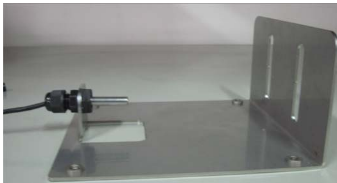
图 3-9 安装温度传感器于主机盒背板上
